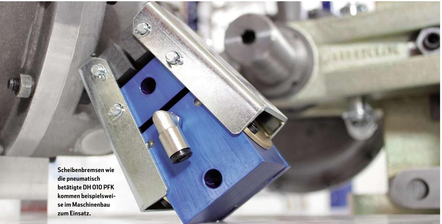
Scheibenbremsen wie die pneumatisch betätigte DH 010 PFK kommen beispielsweise im Maschinenbau zum Einsatz.
