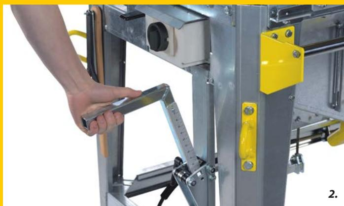
Optimale Kraftübertragung für die mechanische Höhenverstellung: Das Druck-Zugkabel von RINGSPANN RCS wurde vom Handhebel an der Stirnseite der Avola-Tischkreissäge durch die recht verwinkelte Untertisch-Landschaft bis zur beweglichen Aktionseinheit von Sägeblatt und Antrieb geführt. (Bild: Avola / RINGSPANN RCS)
